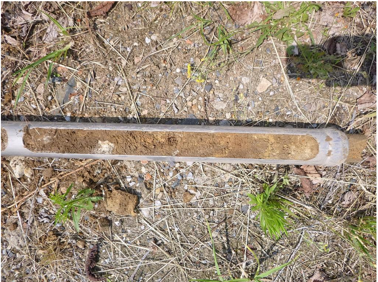
Bild 4: Bohrung 1, schluffig-sandig-kiesig, Auffüllung bis 0,75 m, dann Schluff, feinsandig.
