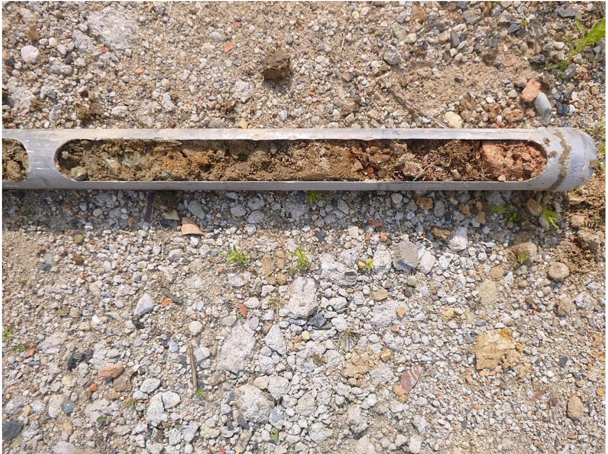
Bild 5: Bohrung 6, Grobkies, mittelmiesig, sandig, schluffig, Auffüllungen bei 0,5-1,0 m.
